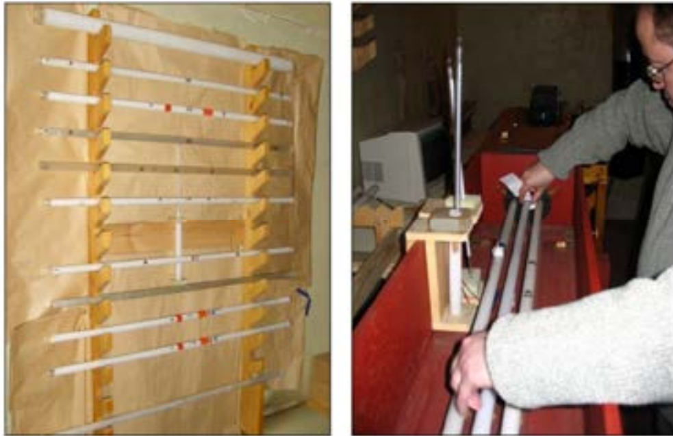
圖 3：左為 Tuorla 實驗室中常用的石英塊規，右為在比長儀中安置石英塊規 (Jokela, 2014; Fig. 3.1)
