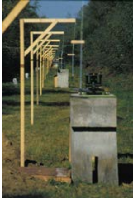
圖 6：匈牙利 Gödöllő 標準基線「Väisälä Comparator」作業時溫度計吊掛 (Jokela, 2014; Fig. 4.16)
