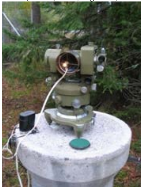
圖 7：整置於經緯儀基樁上之配有共線儀燈具的 Kern DKM3 (Jokela, 2014; Fig. 4.4, Nummela 標準基線)
