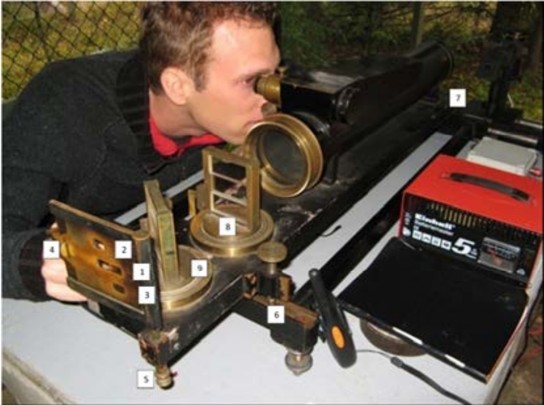
圖11：藉由屏幕與補償玻璃片的調整觀測干涉紋(修改自Jokela, 2014; Fig. 4.8；由Dr. Jorma Jokela 提供)
