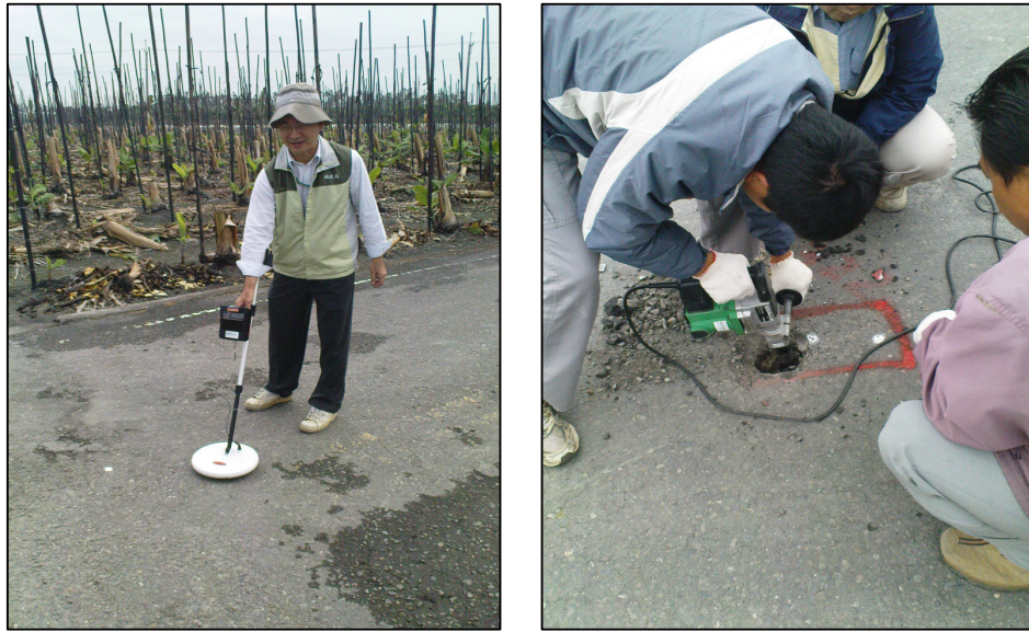
圖 2 以金屬探測器精確定位並挖掘遭掩蔽之已知點
