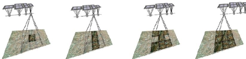
圖 3：MicroSoft UltraCam 分時順序曝光機制設計(MicroSoft 公司提供)
