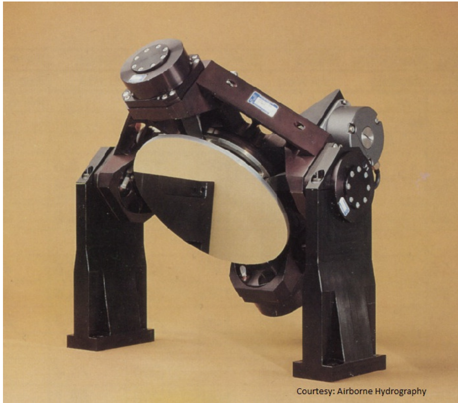
圖 5c：Hawkeye-II 之掃描鏡 (Courtesy of AHAB)
