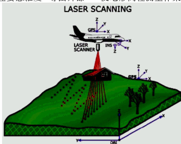
圖 1 空載光達的測量原理圖示 (Renslow, 2001)
